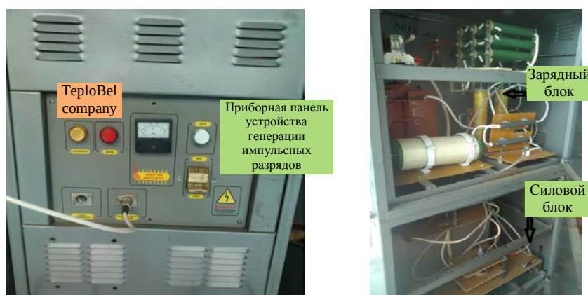
Рис. 3. Внешний вид установки, преобразующей энергию в импульсы тока микросекундной длительности для электрогидравлической обработки нефтесодержащих отходов
