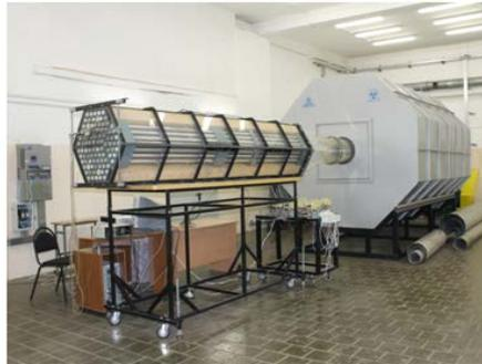
Рис. 4. Экспериментальный стенд НГТУ: 1 – газовый баллон; 2 – редуктор; 3 – базовый блок коммутации/измерения; 4 – модульный газоанализатор; 5 – преобразователи давления; 6 – регулятор расхода газа; 7 – отборный зонд; 8 – статические отборы; 9 – устройство ввода трассера в ячейку экспериментальной модели; 10 – экспериментальная модель; 11 – успокоительный участок; 12 – ресиверная емкость; 13 – вентилятор высокого давления; 14 – преобразователь частоты; 15 – ЭВМ
