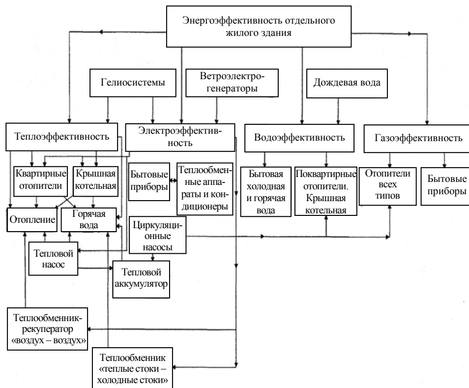
Рис. 1. Принципиальная схема формирования энергоэффективности жилого здания
