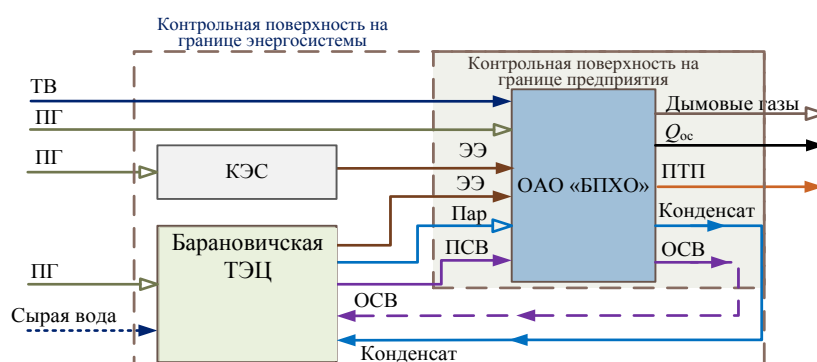
Рис. 4. Структурная схема к расчету балансов энергии и эксергии для ОАО «БПХО» по результатам 2013 г.: ПТП – побочные тепловые потоки; ТВ – техническая вода; ОСВ – обратная сетевая вода; ПСВ – прямая сетевая вода; ПГ – природный газ; Q_{\text{oc}} – потери в отопительной сети
