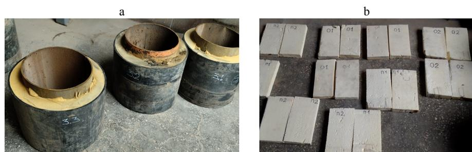
Рис. 3. Образцы труб и пенополиуретана для проведения испытаний
