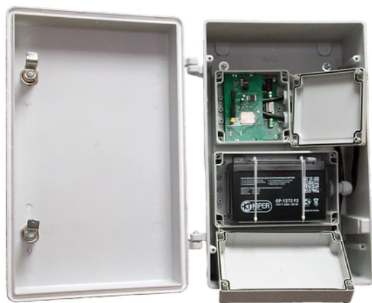
Рис. 4. Комплекс мониторинга защитного потенциала КМЗП [9]
