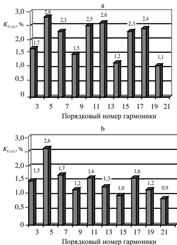
Рис. 9. Гистограммы высших гармоник напряжения в сети насосного агрегата (асинхронный двигатель с преобразователем частоты):
