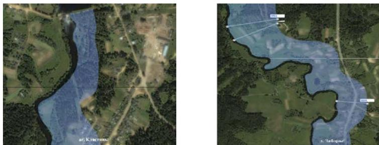
Рис. 6. Расчетные границы зоны затопления территории нижнего бьефа водохранилища Клястицы при разрушении плотины
