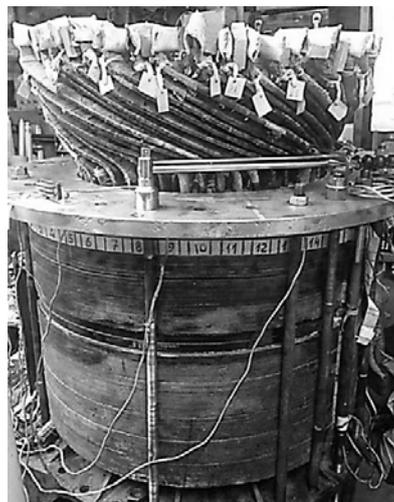
Рис. 6. Масштабная физическая модель торцевой зоны генератора
