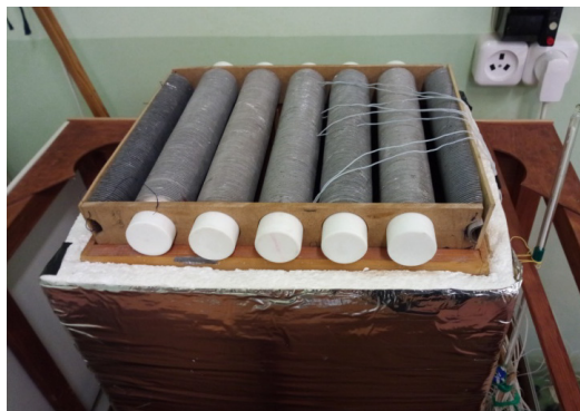
Рис. 3. Экспериментальная установка с пучком над шахтой
