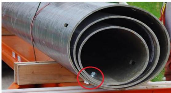
Рис. 3. Принцип хранения и транспортировки композитных стоек
