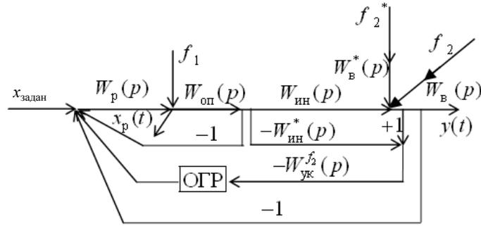
Рис. 5. Структурная схема моделирования переходных процессов инвариантной САР питания:  $W_{ук}^{f_2}(p)$  – передаточная функция устройства компенсации внешнего возмущения;  $W_{ин}^*(p) = W_{ин}(p)$  – то же модели инерционного участка объекта регулирования; ОГР – ограничитель величины коррекции задания (остальные обозначения на рис. 1)
