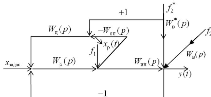
Рис. 1. Структурная схема моделирования типовой трехимпульсной САР с дифференциатором:  $y(t)$  – основная регулируемая величина;  $x_{\text{задан}}$  – заданное значение основной регулируемой величины;  $x_p(t)$  – регулирующее воздействие;  $f_1$  – внутреннее возмущение;  $f_2$  – внешнее топочное возмущение;  $f_2^*$  – внешнее возмущение расходом перегретого пара;  $W_{\text{в}}(p)$  – передаточная функция топочного возмущения;
