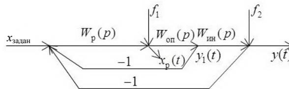
Рис. 3. Структурная схема моделирования двухконтурной САР:
