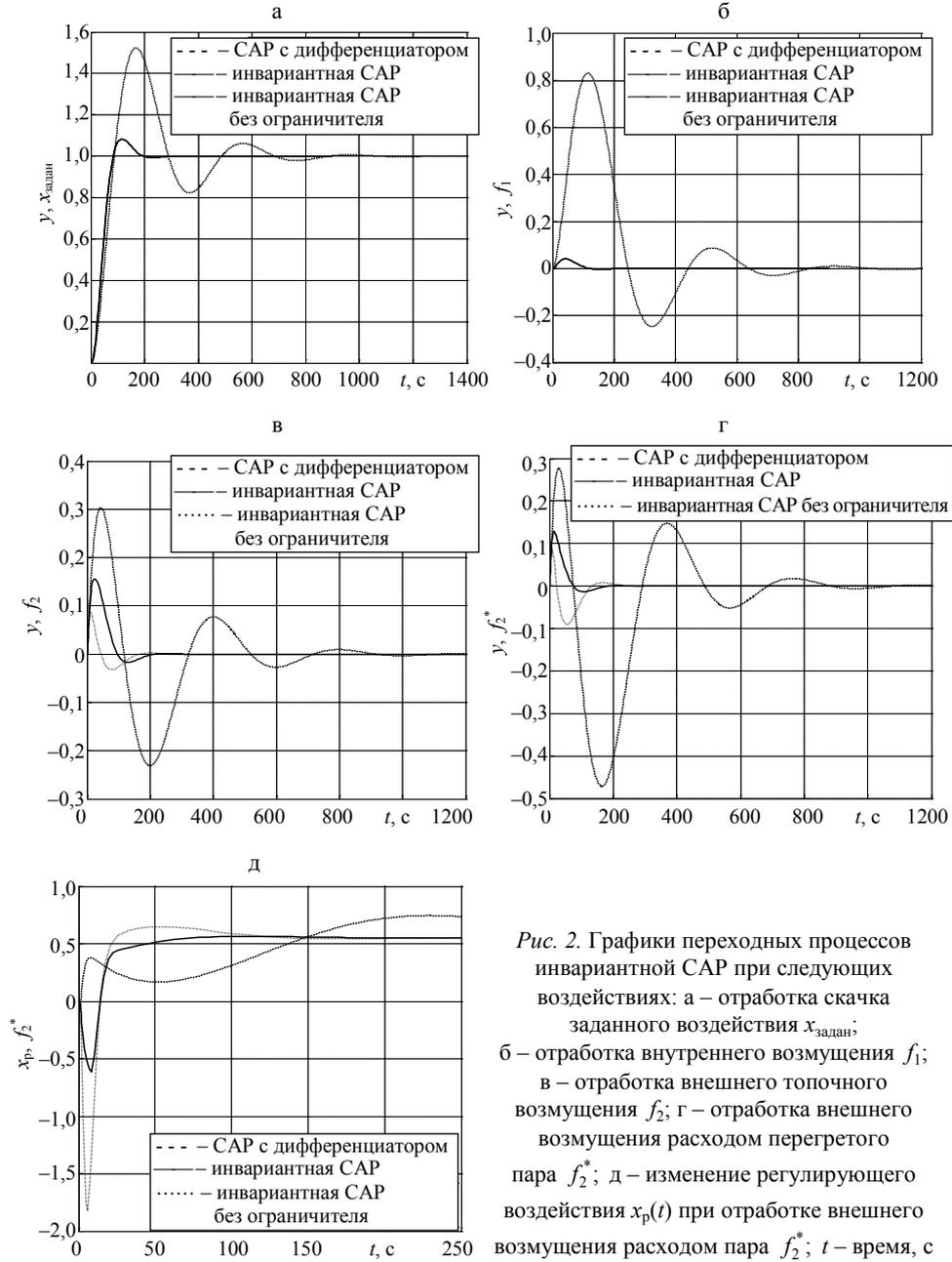
Рис. 2. Графики переходных процессов инвариантной САР при следующих воздействиях: а – отработка скачка заданного воздействия  $x_{задан}$ ; б – отработка внутреннего возмущения  $f_1$ ; в – отработка внешнего топочного возмущения  $f_2$ ; г – отработка внешнего возмущения расходом перегретого пара  $f_2^*$ ; д – изменение регулирующего воздействия  $x_p(t)$  при отработке внешнего возмущения расходом пара  $f_2^*$ ;  $t$  – время, с
