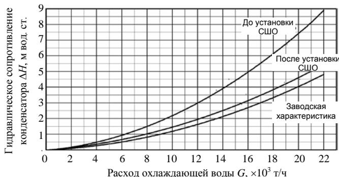
Рис. 3. Гидравлическое сопротивление конденсатора 180-КЦС-1 турбины Т-180/210-130-1 ЛМЗ
