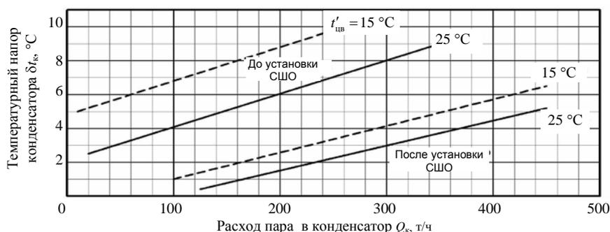
Рис. 2. Температурный напор конденсатора 180-КЦС-1 турбины Т-180/210-130-1 ЛМЗ
