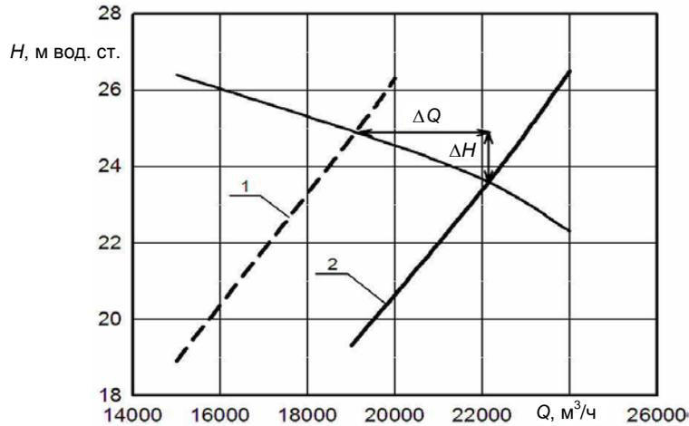
Рис. 1. Характеристика совместной работы циркуляционных насосов и системы циркуляционного водоснабжения до (1) и после (2) внедрения СШО
