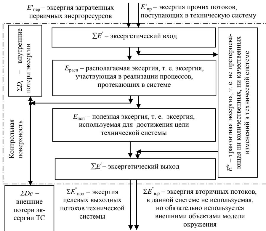
Рис. 1. Схема эксергетических потоков технической системы
