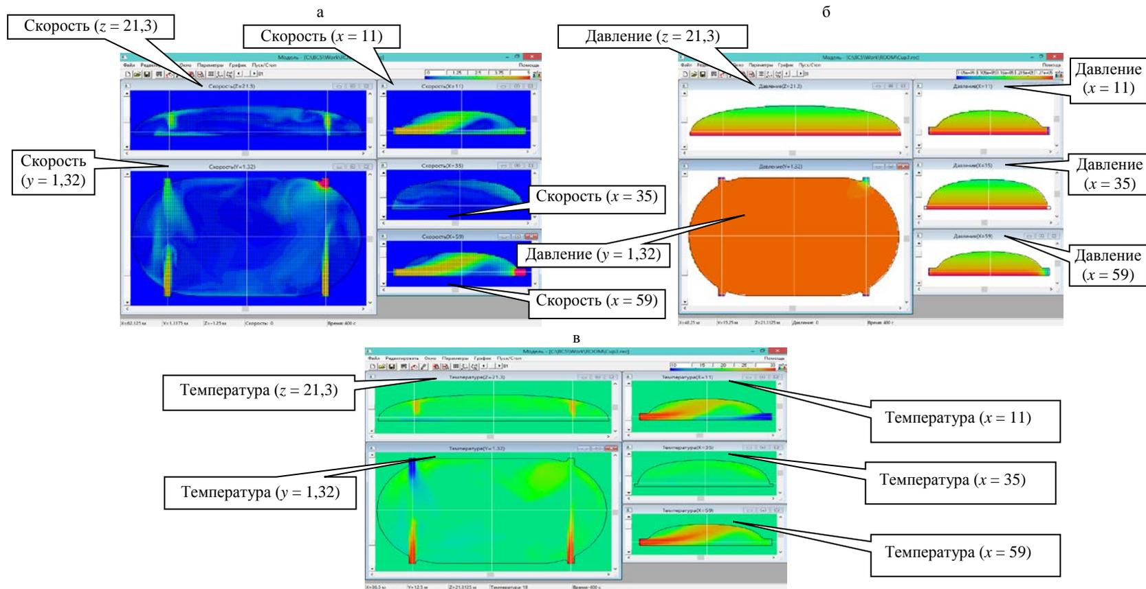
Рис. 5. Распределение расчетных параметров в момент времени 400 с в характерных сечениях при скорости поступления воздуха 5 м/с в полях:
