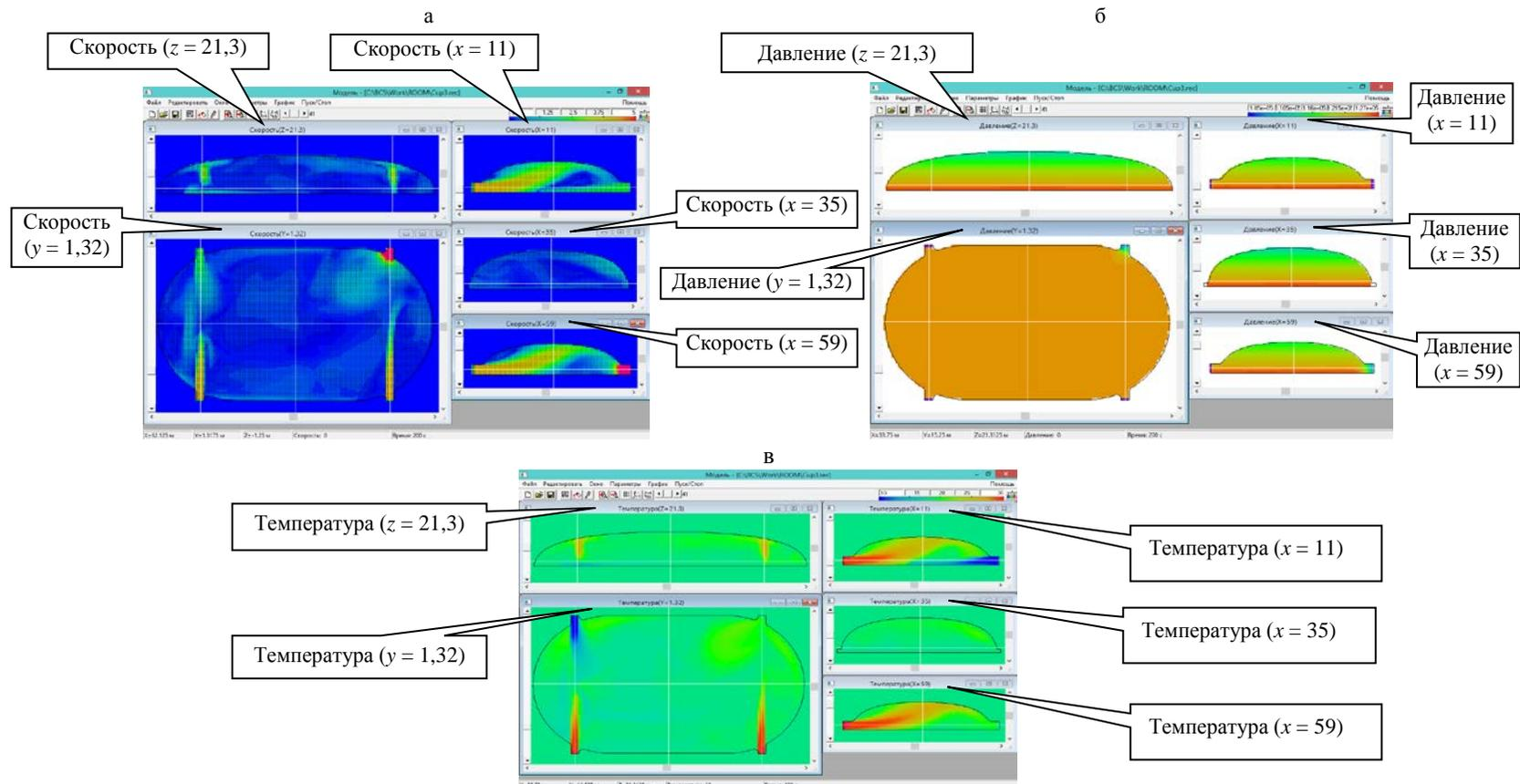
Рис. 4. Распределение расчетных параметров в момент времени 200 с в характерных сечениях при скорости поступления воздуха 5 м/с в полях:
