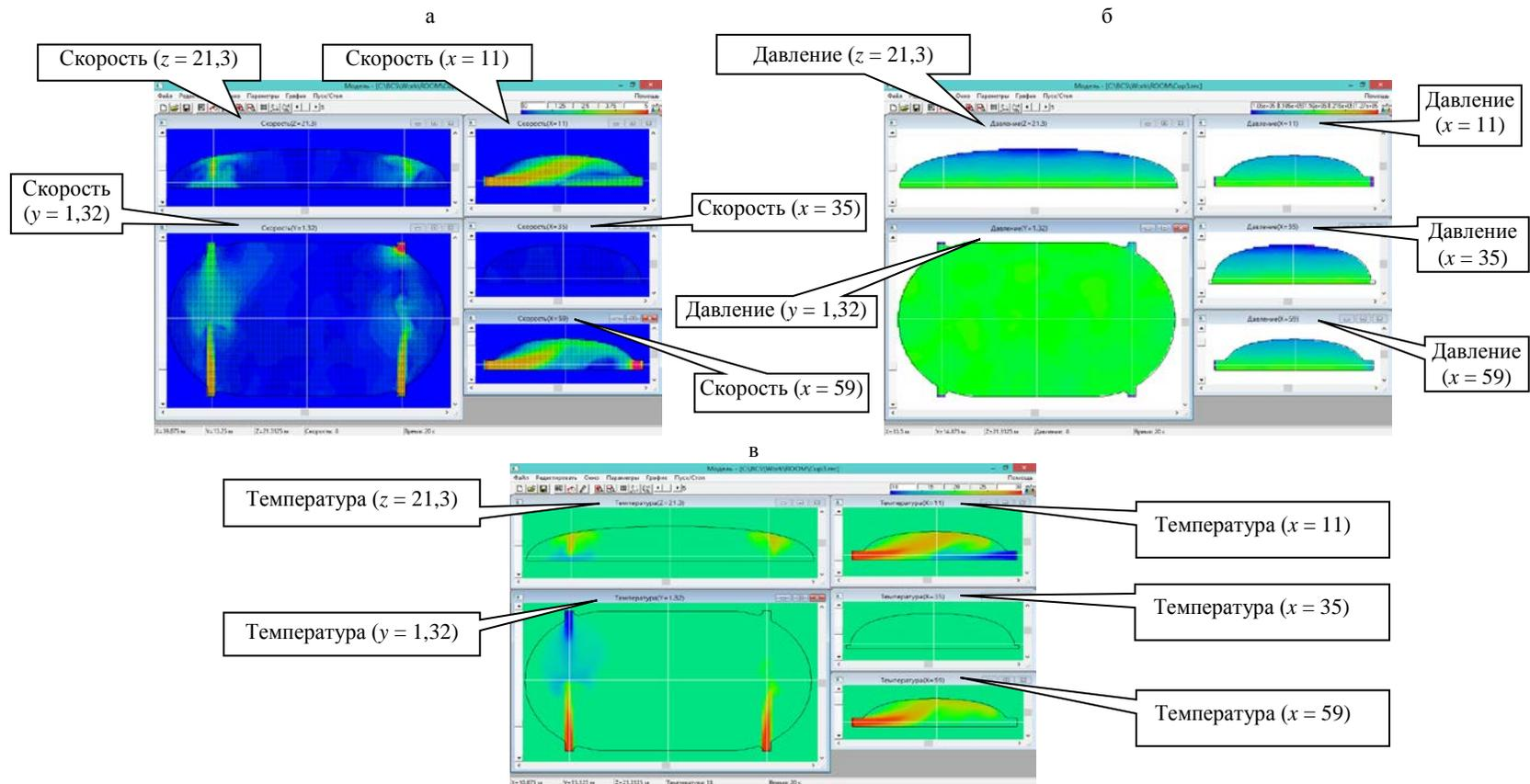
Рис. 2. Распределение расчетных параметров в момент времени 20 с в характерных сечениях при скорости поступления воздуха 5 м/с в полях:
