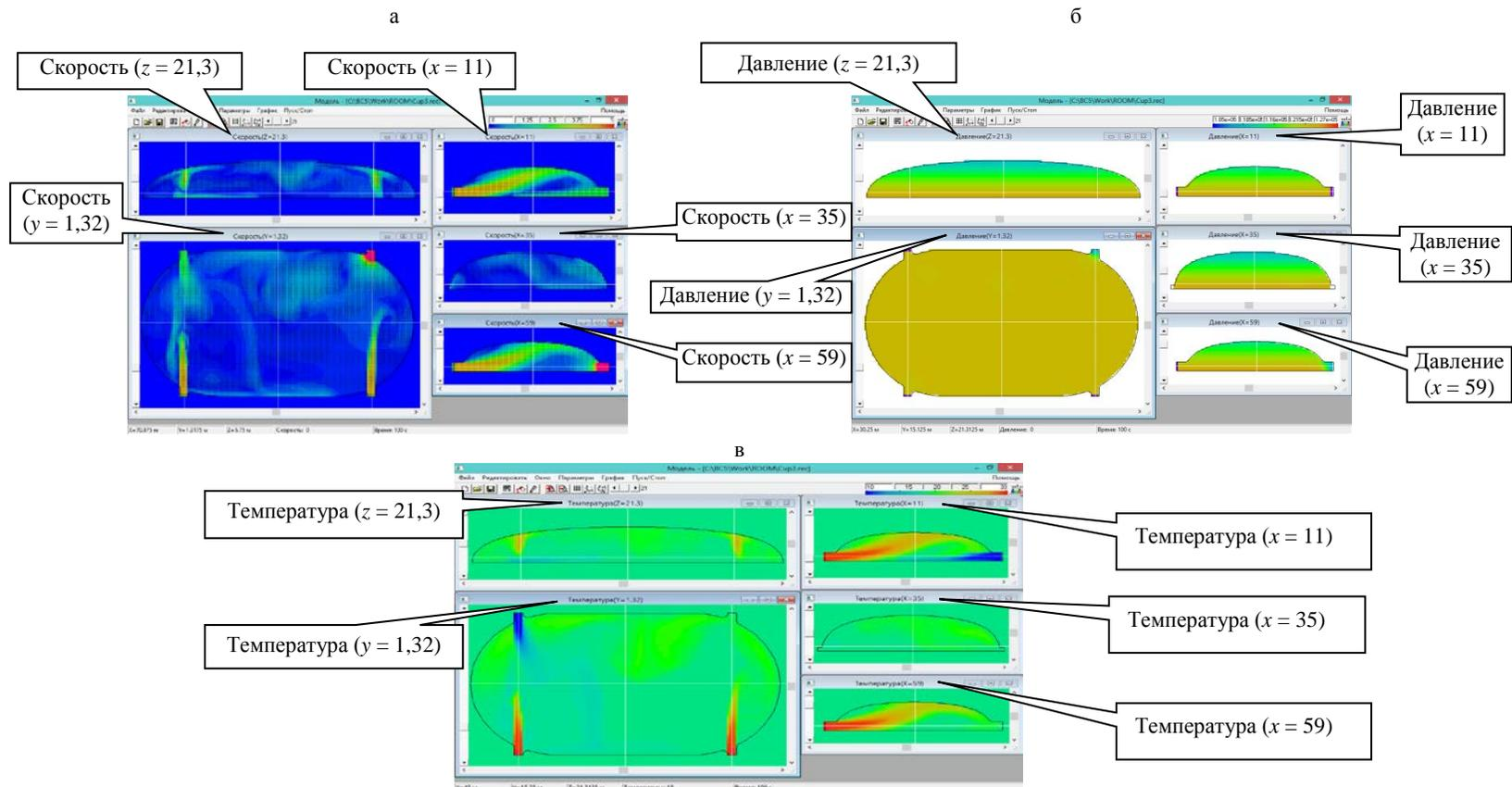
Рис. 3. Распределение расчетных параметров в момент времени 100 с при скорости поступления воздуха 5 м/с в полях:
