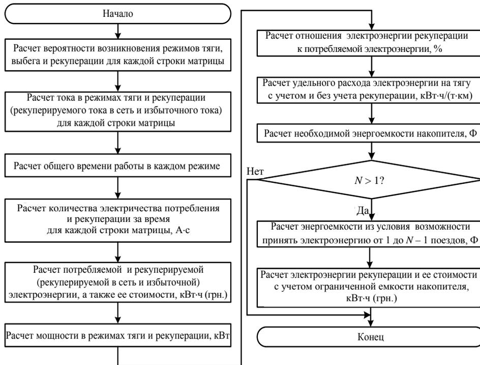
Рис. 3. Блок-схема алгоритма подпрограммы расчета количества электроэнергии (стоимости) и емкости накопителя
