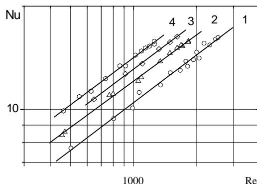
Рис. 1. Зависимость числа  $Nu$  от числа  $Re$ : 1 – образец с оребрением без смещения оси вращения инструмента; 2 – то же со смещением оси вращения инструмента на 40 мм; 3 – то же на 50 мм; 4 – то же на 70 мм
