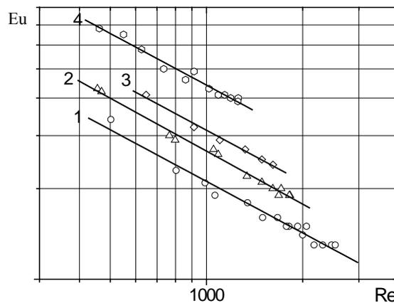
Рис. 2. Зависимость числа  $Eu$  от числа  $Re$ : 1 – образец с оребрением без смещения оси вращения инструмента; 2 – то же со смещением оси вращения инструмента на 40 мм; 3 – то же на 50 мм; 4 – то же на 70 мм
