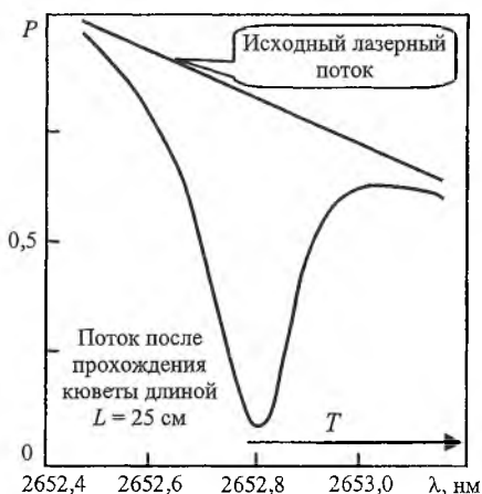
Рис. 2. Зависимости исходной мощности излучения одномодового лазера от длины волны при возрастании температуры его кристалла и мощности излучения после прохождения кюветы с влажным воздухом
