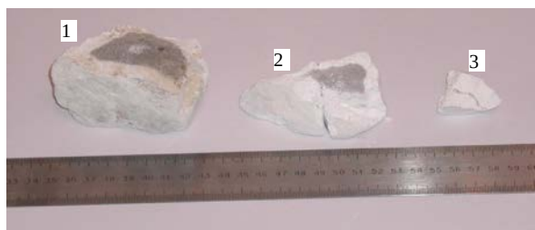
Рис. 1. Образцы извести, отобранные в конце теплотехнологии 24-часового цикла обжига \text{CaCO}_3 в печи обжига извести № 2 РУП «БМЗ»: 1–3 – образцы извести размерами 70, 45 и 20 мм (соответственно d_{\text{экв}} = 25 мм – для первого образца; d_{\text{экв}} = 15 мм – для второго); зона \text{CaCO}_3 в образце № 3 просматривается в виде небольшой полоски (образцы отобраны 28 мая 2004 г.)
