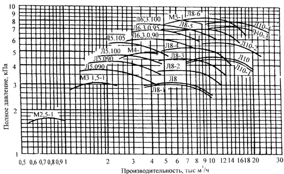
Рис. 4. Характеристика вентиляторов высокого давления (ВР-12-26 и В-Ц6-28) для модульного унифицированного промышленного рекуператора (модуль I, «Силал» М-I 115×460×860-05 и модуль II, «Силал» М-II 230×460×860-1,0)
