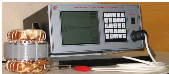
Рис. 4. Прибор для диагностики обмоток электрооборудования ДО-1
