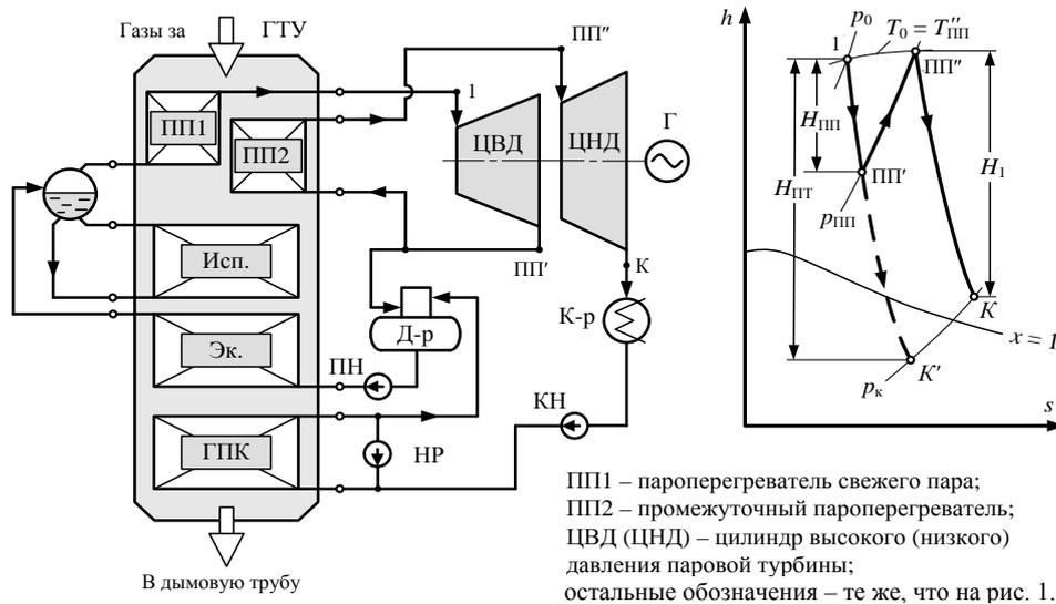
Рис. 2. Принципиальная схема одноконтурной ПГУ с ПП, выполненным параллельно пароперегревателю свежего пара, и *hs*-диаграмма процесса расширения в паровой турбине: 1–ПП'–ПП''–К – одноконтурная ПГУ с ПП; 1–К' – одноконтурная ПГУ без ПП
