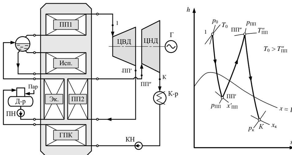
Рис. 3. Принципиальная схема одноконтурной ПГУ с ПП, выполненным параллельно экономайзеру, и  $h$ - $s$ -диаграмма процесса расширения в паровой турбине
