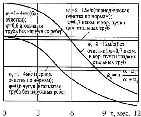
Рис. 3. Зависимость  $k_{\psi} = f(\tau, w_r)$  для трубных коридорных (шахматных), трубных стальных пучков и чугунных шахматных пучков без оребрения со стороны продуктов сгорания (топливо – мазут М80 и М100) (по материалам В. А. Григорьева)
