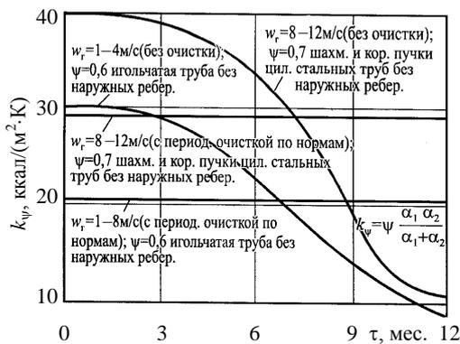
Рис. 2. Зависимость  $k_{\psi} = f(\tau, w_r)$  для трубных коридорных (шахматных), трубных стальных пучков и чугунных шахматных пучков без оребрения со стороны продуктов сгорания (топливо – природный газ) (по материалам В. А. Григорьева)
