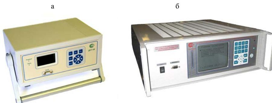
Рис. 2. Измерительные средства для испытания электроэнергетического оборудования: а – силовых трансформаторов – прибор ДСТ-1М; б – электрических машин постоянного тока – диагностический комплекс ИПЭМ
