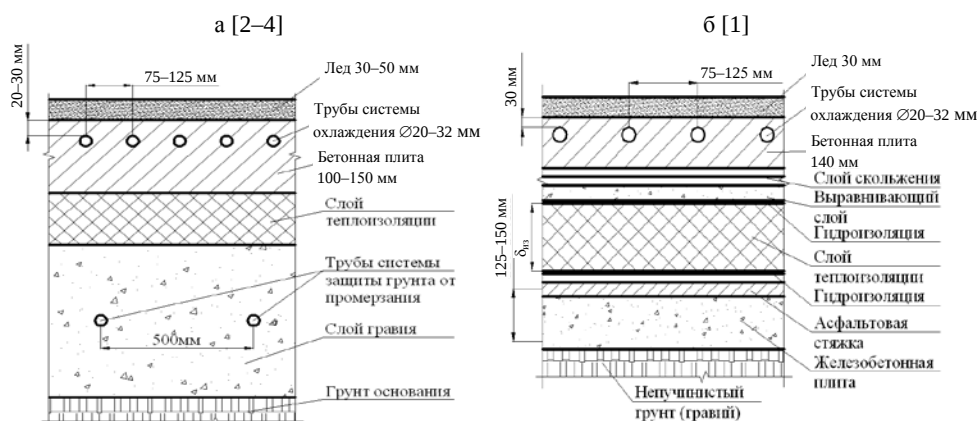
Рис. 1. Варианты конструкции оснований ледовых полей
