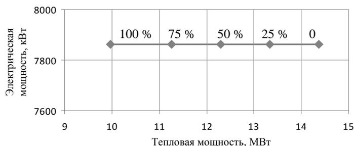
Рис. 7. Зависимость электрической мощности от тепловой при увеличении степени регенерации при  $T_{oc} = 10^\circ\text{C}$
