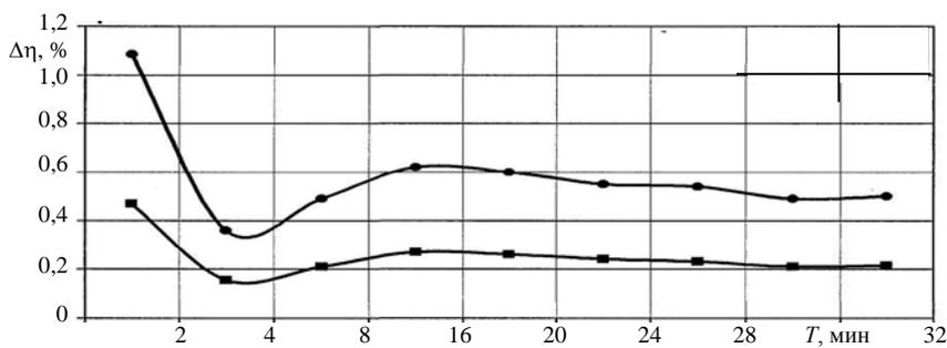
Рис. 1. Экспериментальные кривые зависимости КПД блока от периода колебания мощности (для блоков 300 МВт): —●—  $A = 20$  МВт; —■—  $A = 10$  МВт
