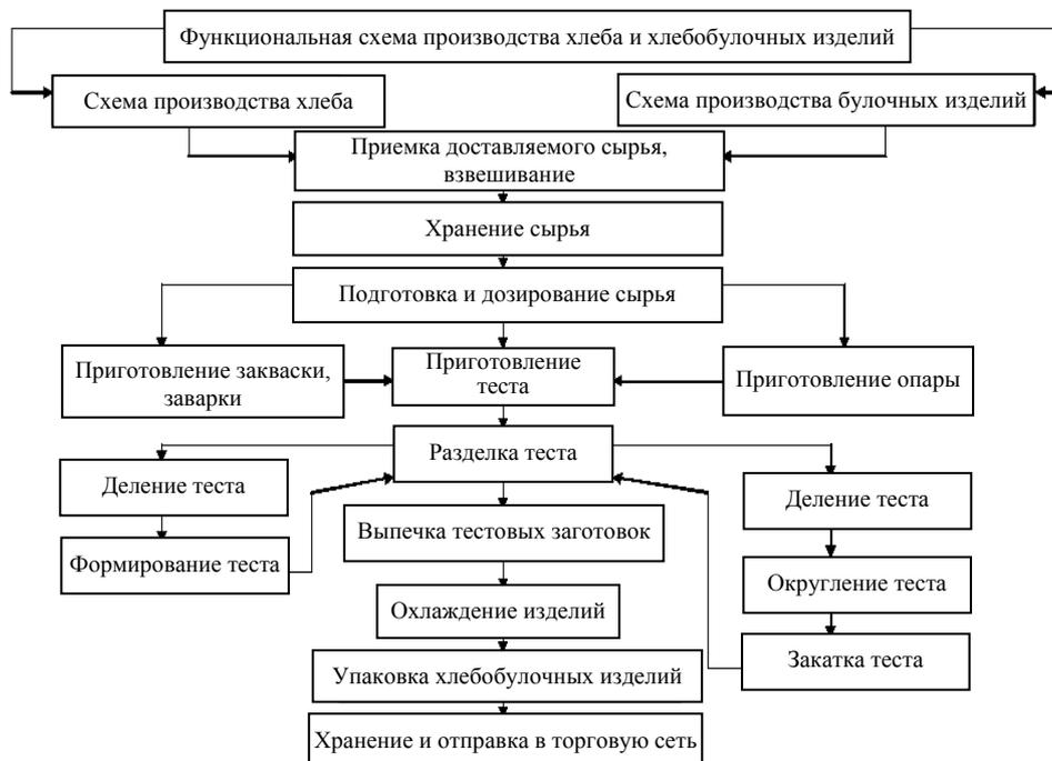
Рис. 1. Функциональная схема производства хлебобулочных изделий
