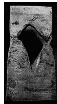
Рис. 5. Сквозное отверстие в слябе, появившееся вследствие большой скорости нагрева при прокатке непрогретого слитка на блюминге [4]
