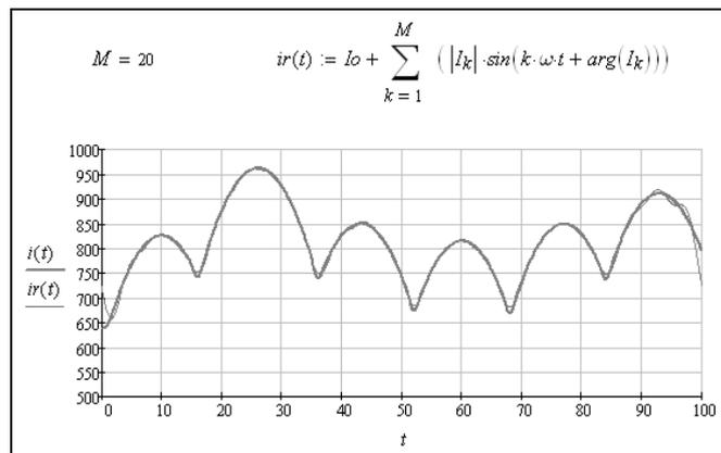
Рис. 5. Графики тока  $i(t)$  и  $ir(t)$  при  $M = 20$
