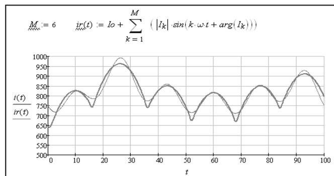
Рис. 6. Графики тока  $i(t)$  и  $i_r(t)$  при  $M = 6$
