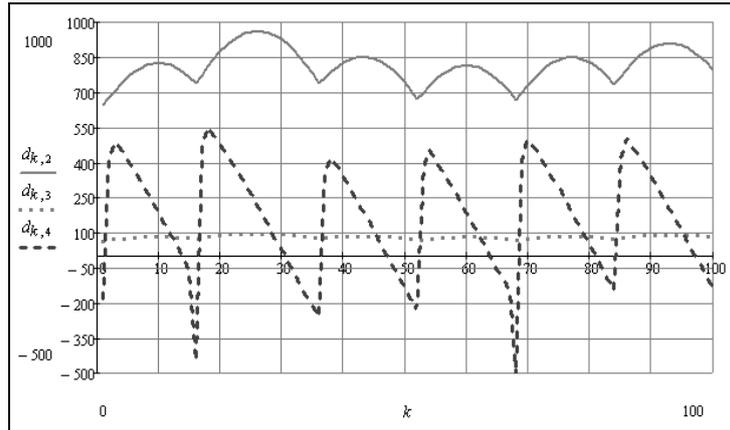
Рис. 2. Графики расчетных функций из файла данных «Rez.dat»:  $d_{k,2}$  – ток нагрузки преобразователя (дуги);  $d_{k,3}$  – напряжение на дуге;  $d_{k,4}$  – то же на выходе преобразователя
