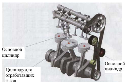
Рис. 9. Пятикратный двигатель с тремя цилиндрами
