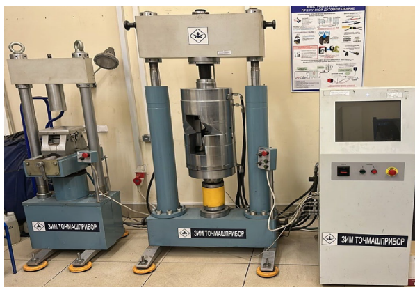
Рис. 11. Универсальная разрывная машина РМ-50УМ1
