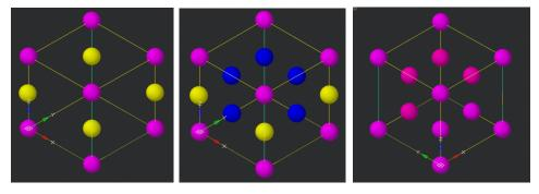
Рис. 2. Схемы кубической кристаллической структуры дендрита в рентгено-дифракционном представлении его состава. Желтый шар – атомы С, фиолетовый шар – Fe, синий шар – О. Слева направо представлены мартенсит, перовскит, нержавеющая сталь
