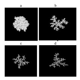
*Рис. 6.* Модельные изображения DLA-фрактальных структур островка, возникающих при величине вероятности s агрегации частиц: a-0.01; b-0.10; c-0.50; d-1.00
