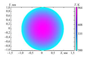
$Puc.\ 1.\$ График распределения температуры T на поверхности (координаты X–Y) нержавеющей стали при воздействии лазерного пучка радиусом 2,0 мм. Показана область возникновения дендритов. Соответствующая температура указана цветом, и она зависит от времени лазерного облучения. Приведенная сине-фиолетовая область — реализация синтеза дендритов
