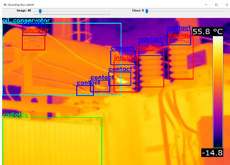
Рис. 2. ИК-изображение силового трансформатора с нанесенными вручную граничными рамками в программе OpenLabeling; различный цвет рамок обозначает принадлежность к соответствующим классам: «красный» – «изолятор», «синий» – «контактное соединение», «зеленый» – «радиатор», «бирюзовый» – «расширительный бак»
