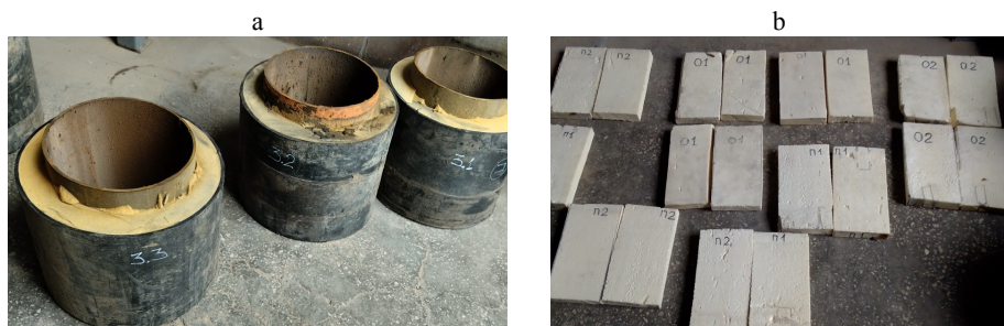
Рис. 3. Образцы труб и пенополиуретана для проведения испытаний
