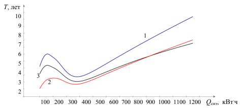
Рис. 7. Простой срок окупаемости (лет) как функция от энергетической емкости СНЭ:  $1-\text{основной расчет для предприятия; } 2-\text{расчет при } K_{\scriptscriptstyle \rm M}=1;$   $3-\text{расчет при условии } C_{\scriptscriptstyle \rm День}/C_{\scriptscriptstyle \rm Hoчь}=2$
