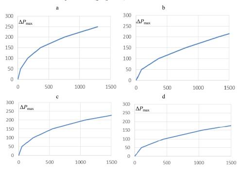
$Puc.\ 2.$  Снижения пиковой нагрузки  $\Delta P_{\max}$  в зависимости от энергии компенсации пикового потребления  $Q_2$ : а — зимний рабочий день (отрезки соответствуют статистическому разбросу в два стандартных отклонения); b — зимний выходной день; c — летний рабочий день; d — летний выходной день
