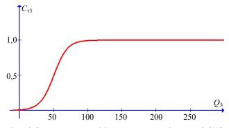
Рис. 3. Экономический эффект выполнения функции 3 СНЭ в зависимости от выделенной энергетической емкости
