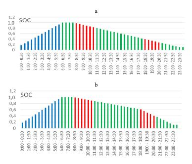
Рис. 5. График состояния зарядки СНЭ на литий-ионных АКБ: а – равномерная разгрузка СНЭ, b – оптимизированная разгрузка (синий цвет диаграммы – время ночного тарифа, красный – утренний и вечерний пики энергопотребления)
