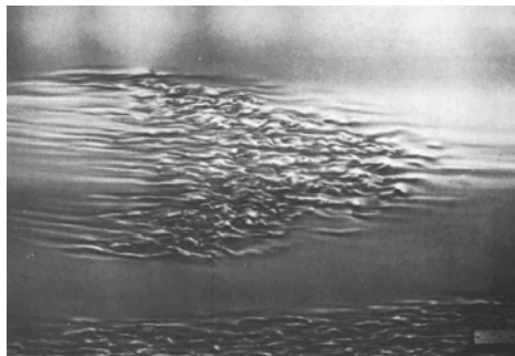
Рис. 2. Турбулентное пятно Эммонса (получено с использованием суспензии алюминиевых хлопьев в воде)
