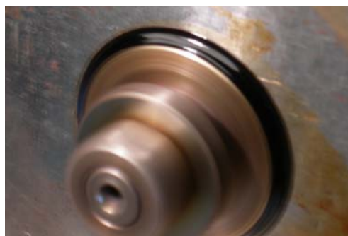
Рис. 9. Магнитная жидкость ММт-50 с многослойными углеродными нанотрубками у поверхности вала
