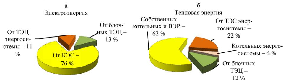
Рис. 3. Структура генерации потоков электро- (а) и тепловой энергии (б) для энергообеспечения промышленного производства продукции
