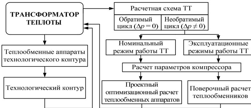
Рис. 2. Схема комплексного метода расчета трансформатора теплоты
