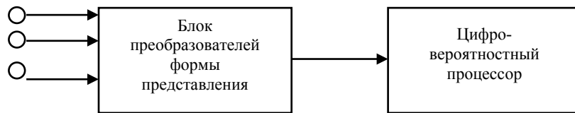
Рис. 1. Схема измерительного контроллера
