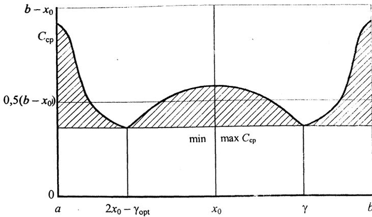
Рис. 6. Средняя цена распознавания грубой погрешности измерения при отклонении границ принятия решения от оптимальных по критерию минимакса при равномерном распределении контролируемой переменной
