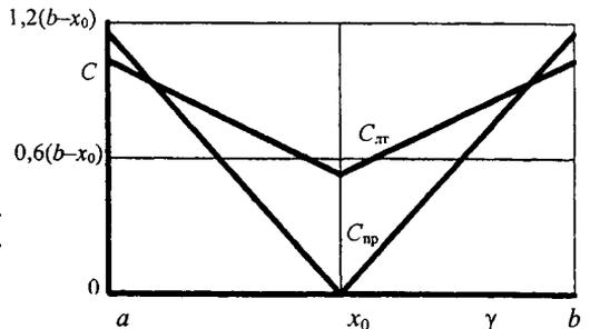
Рис. 3. Цены ошибок принятия решения по критерию минимакса при равномерном распределении контролируемой переменной
