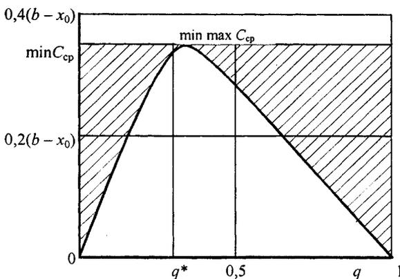
Рис. 5. Средняя цена распознавания грубой погрешности измерения по критериям Байеса и минимакса при равномерном распределении контролируемой переменной
