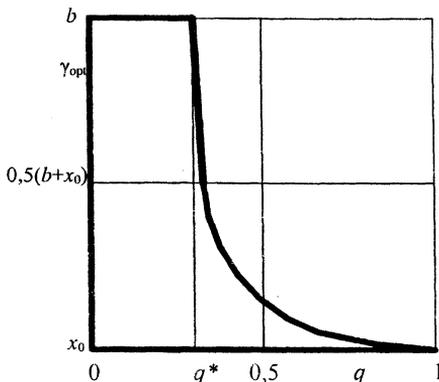
Рис. 4. Оптимальная граница принятия решения по критерию Байеса при равномерном распределении контролируемой переменной
